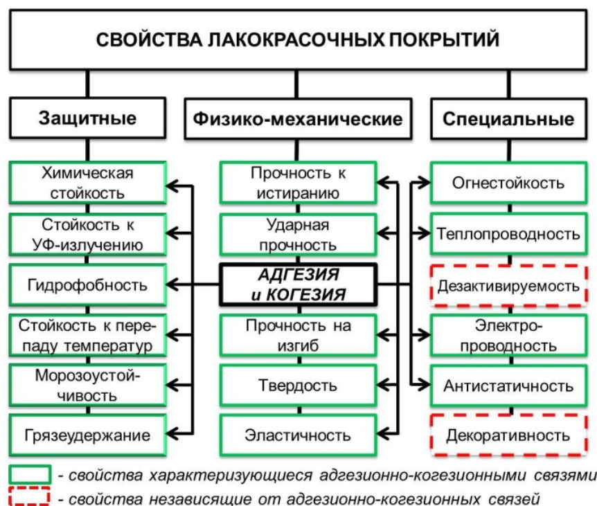
Рисунок 1 – Схема влияния адгезии и когезии на свойства лакокрасочных покрытий
