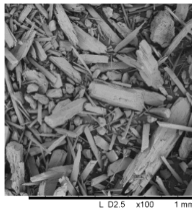
Рисунок 1. Электронная микрофотография волластонита (100-кратное увеличение)
