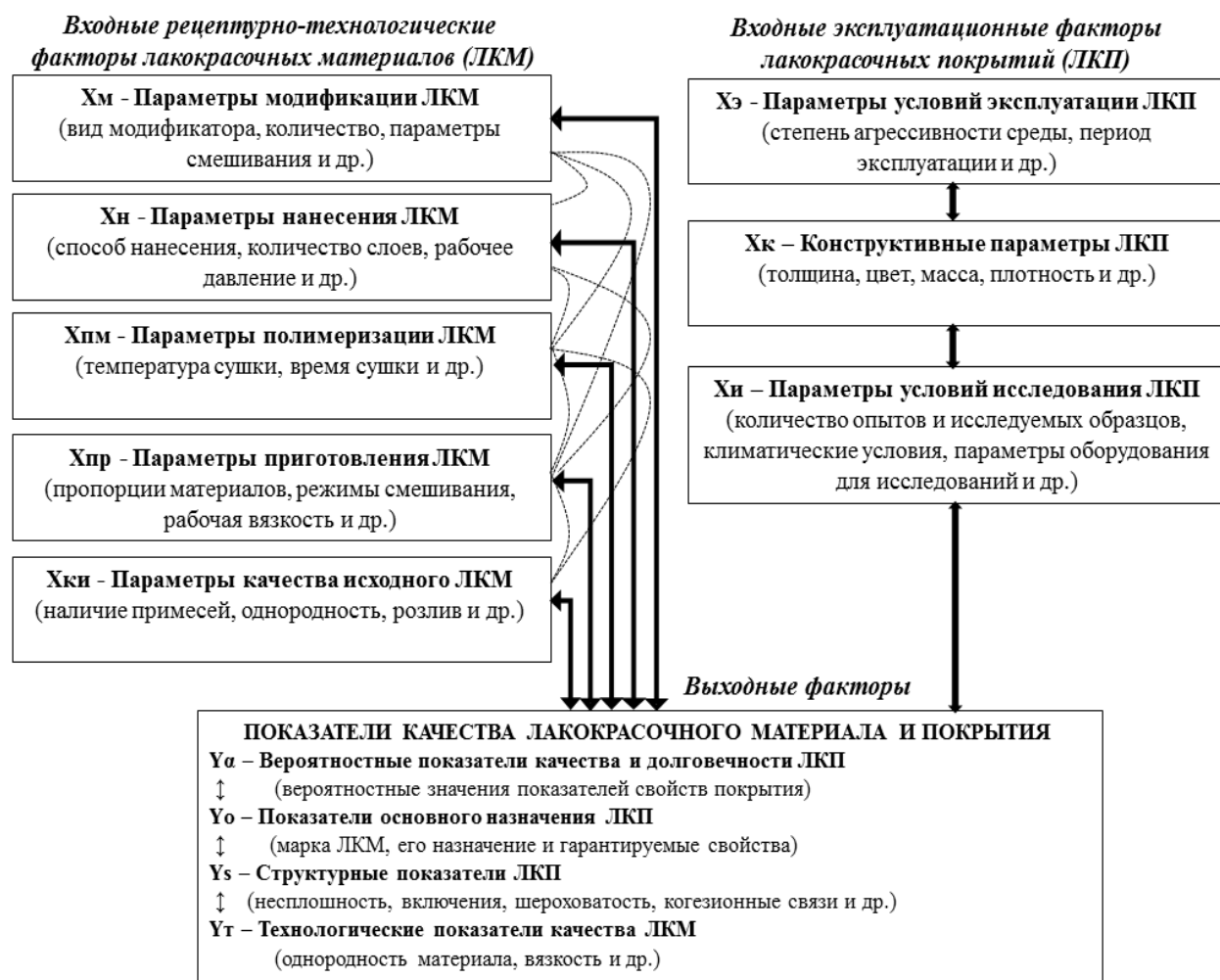
Рисунок 2 – Факторная система технологии создания лакокрасочных покрытий
