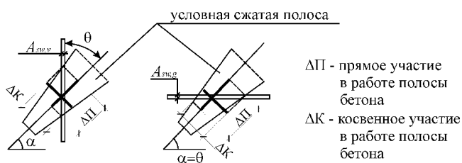
Рис.2. Схема участия поперечной арматуры в работе наклонной сжатой полосы
