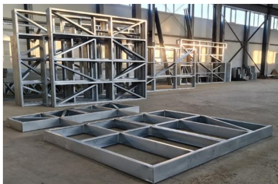
Рис. 5. Варианты укрупненной, панельной сборки и поставки конструктивных систем
