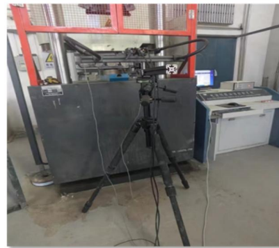
Рис. 7 Схема испытания механических свойств бетона на основе шламовой золы
