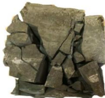
Рис. 4. Образцы цементного камня: а) при нормально условиях; б) был выдержан в соляном растворе на протяжении 45-ти суток [8]
