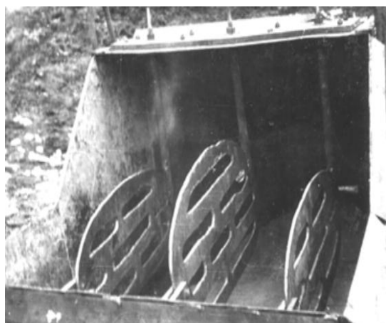
Устройства для предварительного электроразогрева бетонной смеси, разработанные под руководством А.С. Арбенёва. 1965 – 1967 гг.
