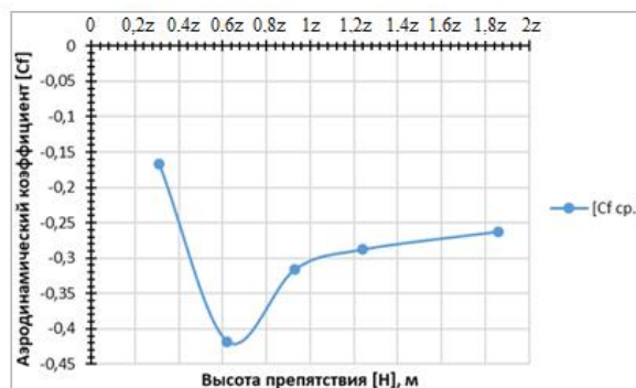
Рис. 11. График зависимости среднего аэродинамического коэффициента [Cf] по поверхности сооружения (в плоскости по середине) от изменения [H]
