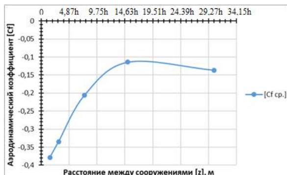
Рис. 8. График зависимости среднего аэродинамического коэффициента [Cf] по поверхности сооружения (в плоскости по середине) от изменения [z]
