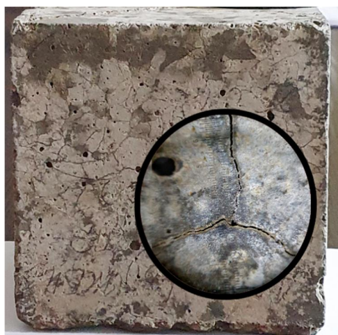
Рисунок 3 – Вид образца №3 после 285 циклов серии 4, с шириной раскрытия трещины 0.05 мм; K п = 0,67; M = 226 циклов, марка F 2 200
