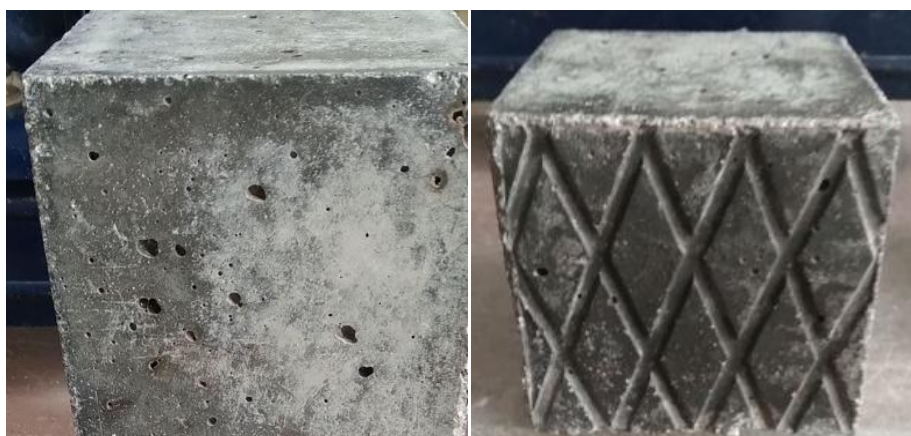
Рисунок 6 – Вид образцов после 365 циклов замораживания и оттаивания. Трещины определены микроскопом МПБ-2
