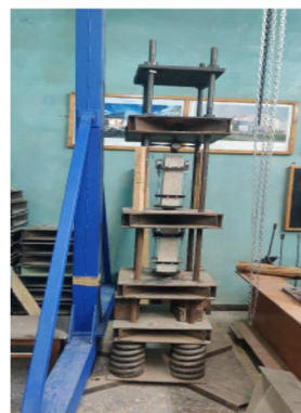
Рисунок 2 – Образец и установка для испытания на длительное сжатие
