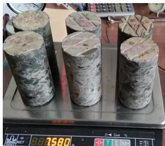
Рисунок 4 – Вид образцов кернов диаметром 69,2 мм, высотой 140 мм взятых из плит и переданных в научно производственную лабораторию Приморского Агро-технологического Университета (ПГАТУ)
