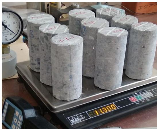
Рисунок 5 – Вид образцов кернов после 200 циклов замораживания и оттаивания по второму базовому методу
