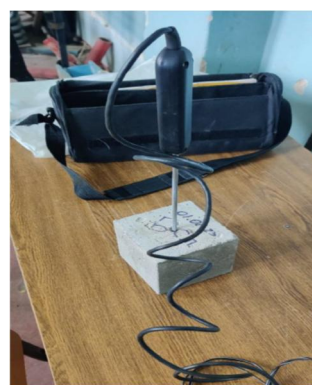
Рисунок 3 – Измерение коэффициента теплопроводности прибором ИТП-МГ4 «Зонд» (А-фиксация щупа-датчика в образце, Б – прибор с индикацией показаний)
