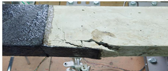
Рисунок 11 – Разрушение образца Б0-0
