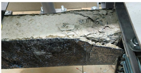
Рисунок 10 – Разрушение образца Б1-0
