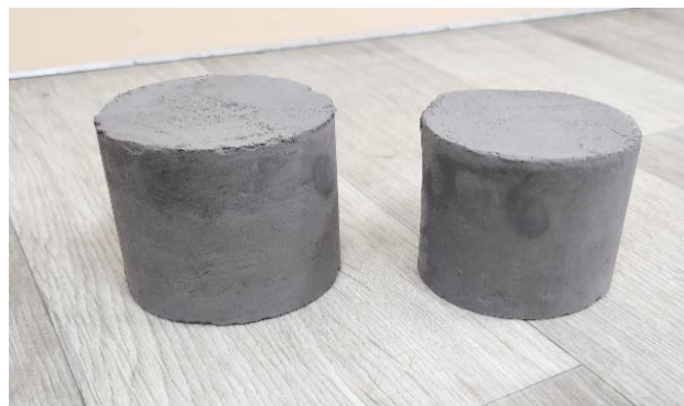
Рис. 4. Образцы-сырцы, высушенные до постоянной массы, полученные на лабораторном экструдере ЭМ-1В
