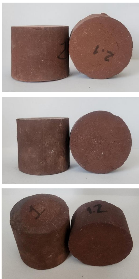
Рис. 6. Керамические образцы, полученные пластическим формованием при температуре обжига 1050°C, 1150°C и 1180°C
