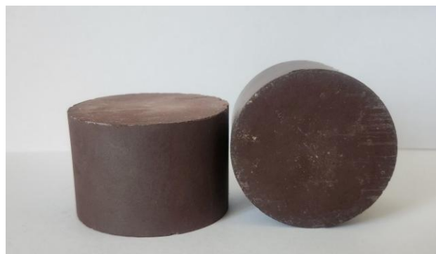
Рис. 5. Керамические образцы, полученные полусухим прессованием при температуре обжига 1050°C, 1150°C и 1180°C.
