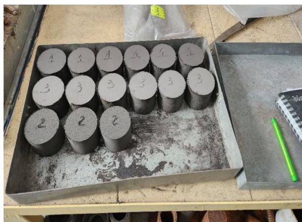
Рис. 3. Образцы-сырцы, высушенные до постоянной массы, полученные при полусухом прессовании
