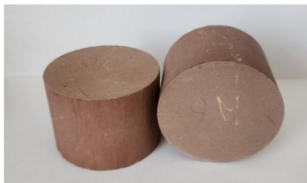
Рис. 4. Образцы-сырцы, высушенные до постоянной массы, полученные на лабораторном экструдере ЭМ-1В
