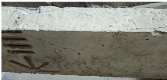
Рисунок 9 – Разрушение образца Б0-0
