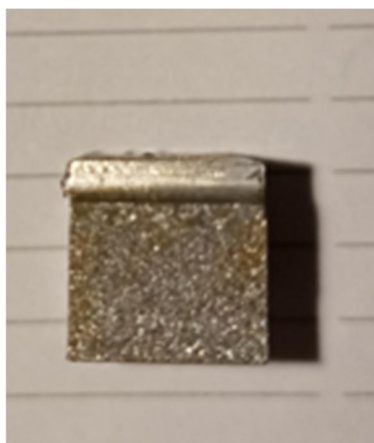
Рис. 5. Образец, сваренный по ГОСТ 8713-79 (Н)
