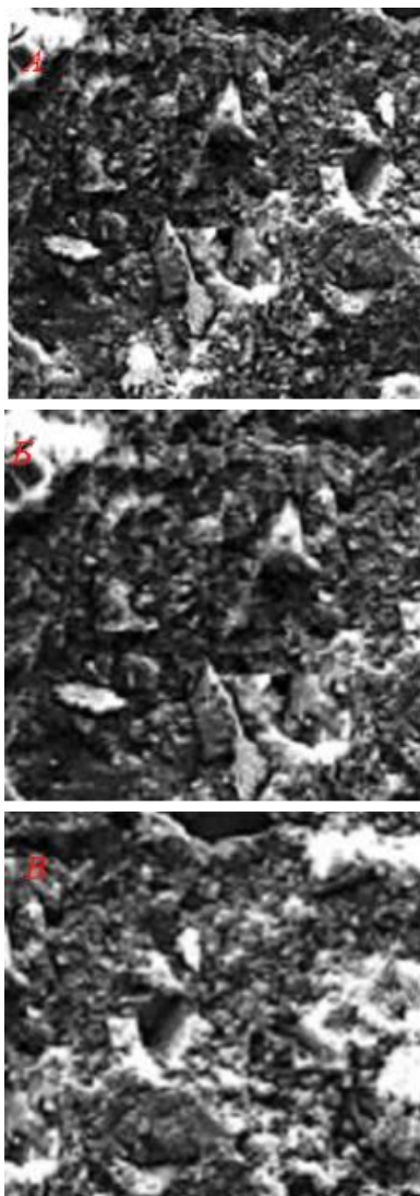
Рис. 5. Микроструктура образцов железо-сернистого вяжущего камня с добавками серы 6 % (А), 8% (Б) и 10% (В) по массе
