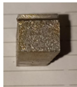
Рис. 7. Образец, сваренный по ГОСТ 14771-76 (Н)
