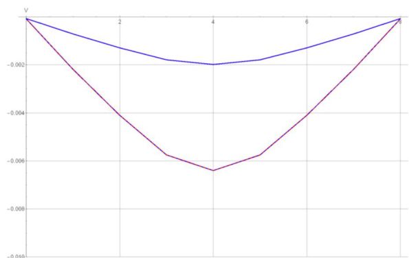
Рис. 5.4. Эпюры прогибов в ригеле железобетонной рамы (м) после двух итераций (красный цвет)
