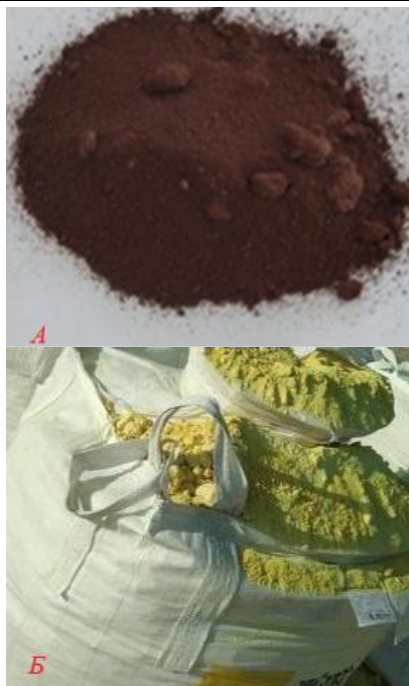
Рисунок 1 - Внешний вид и форма частиц пиритного огарка (А) и технической серы (Б)
