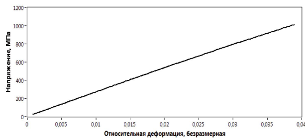
Рис. 1. График «напряжение-деформация» для базальтовой арматуры при продольном изгибе стержня [11]
