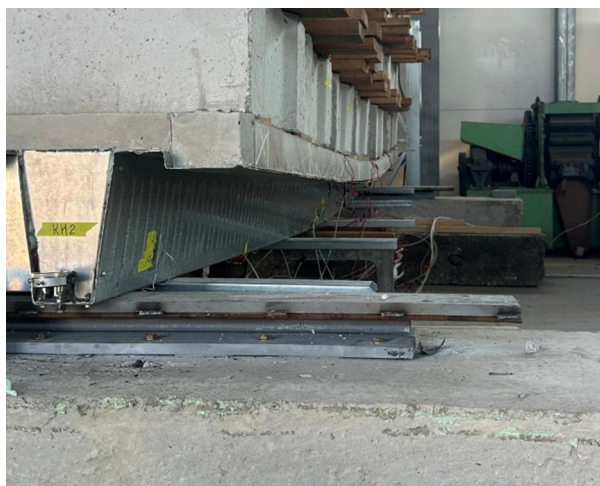
Рис. 9. Прогиб плиты при нагрузке 2349 кг/м 2
