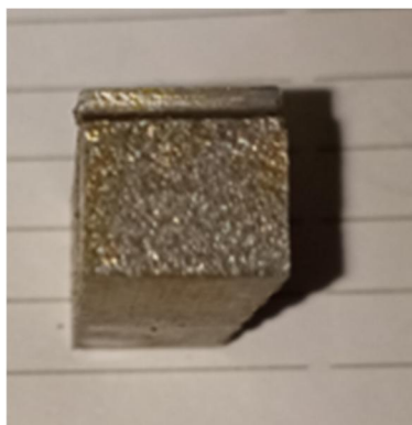
Рис. 4. Образец, сваренный по ГОСТ 8713-79 (КП+УО)
